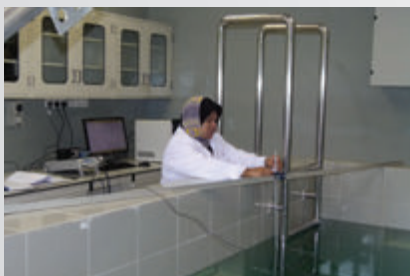
Pengujian halaju bunyi dalam air menggunakan Pulse Echo Measurement System
