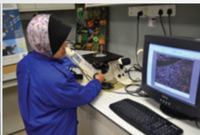
Mencari saiz grain dengan menggunakan Optical Microscope
