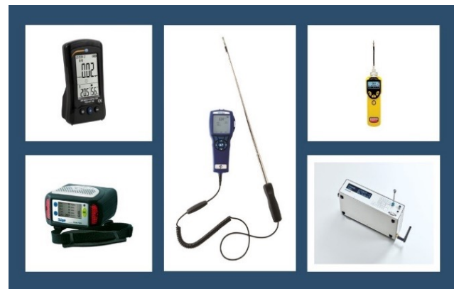
Foto 1: Pengesan gas mudah alih yang terdapat di Makmal STRIDE bagi menentukan kualiti udara kapal selam
